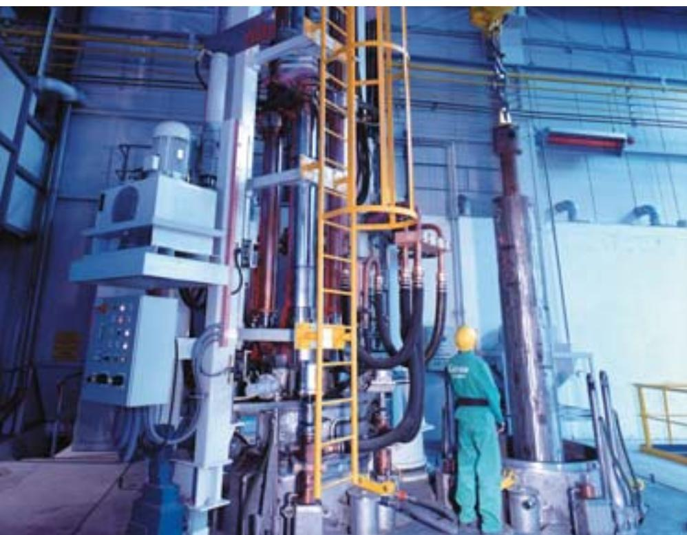
ESU – Eine von BÖHLER entwickelte und bewährte Umschmelztechnologie gibt dem Werkstoff die nötige Homogenität. Voraussetzung für beste Gebrauchseigenschaften.
